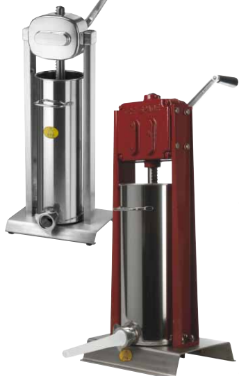
Korvspruta 15-L, handkraft Två utväxlingar för matarkolven. 4 st korvrör: (inner-/ytterdiam.) 10/14, 19/22, 24/28, 33/38 mm. Art.nr 28-4015
