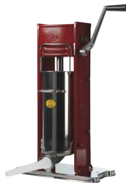
Korvspruta, RFR/handkraft Två utväxlingar för matarkolven. 4 st korvrör: (inner-/ytterdiam.) 10/14, 19/22, 24/28, 33/38 mm.
